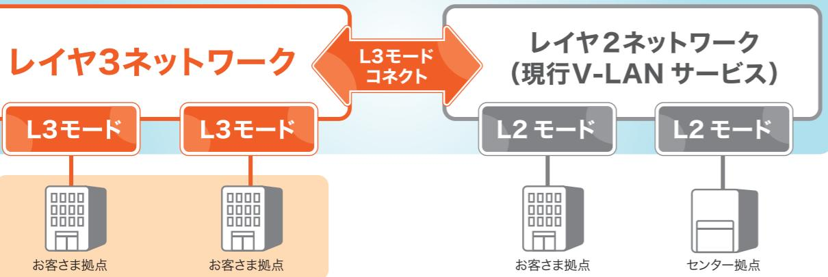
従来のイーサネットフレームによる伝送交換方式「L2モード」に加え、新たにインターネットプロトコル(IP)による伝送交換方式を実現。「L3モード」と「ルータレス機能」によりルータやL3スイッチが不要となり、機器コストおよび保守コストの低減が期待できます。
