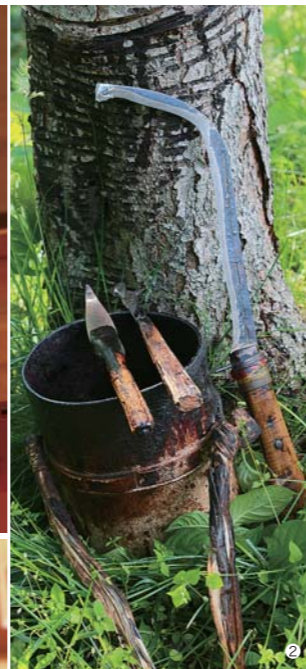
② 漆掻きの道具。(右から)木の皮を削るカマ、キズをつけるカンナ、漆を掻くヘラ、採った漆を入れるタカッポ。③ 滴生舎の塗師たちは、実践で仕事を学んでいきます。塗師が用いる刷毛は、コシのある女性の髪の毛が使用されています。道具を作る職人は現在日本で2人のみ。④ 主に下地の工程で使用されるヘラは大小さまざまあり、漆を混ぜたり、塗ったりするほか、塗った漆がはみ出した時にすき取るなど、作業用途に応じて使い分けします。
