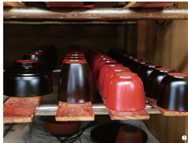
① 工房内の漆風呂。漆を均一に固めるため、温度・湿度ともに一定の状態を保ちます。その時々漆の質によっても温度を調整します。
