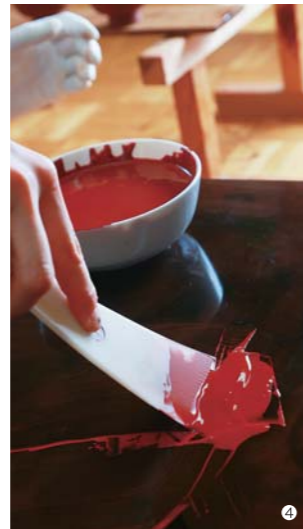
② 漆掻きの道具。(右から)木の皮を削るカマ、キズをつけるカンナ、漆を掻くヘラ、採った漆を入れるタカッポ。③ 滴生舎の塗師たちは、実践で仕事を学んでいきます。塗師が用いる刷毛は、コシのある女性の髪の毛が使用されています。道具を作る職人は現在日本で2人のみ。④ 主に下地の工程で使用されるヘラは大小さまざまあり、漆を混ぜたり、塗ったりするほか、塗った漆がはみ出した時にすき取るなど、作業用途に応じて使い分けします。
