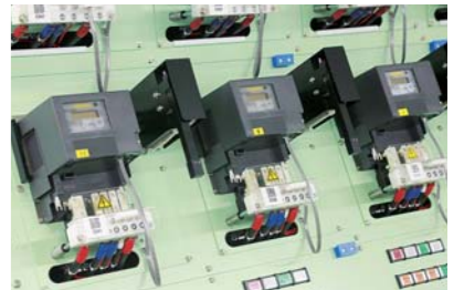
製造中の「スマートメーター」。電力量計をデジタル化したもので、ITネットワークにより自動的に電気使用量が電力事業者へ届きます。
