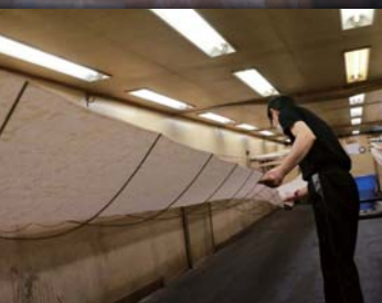
糊置きし、伸子(しんし)張りした生地を染める地染めの様子。室内を空調で暖め、常に除湿しています。
