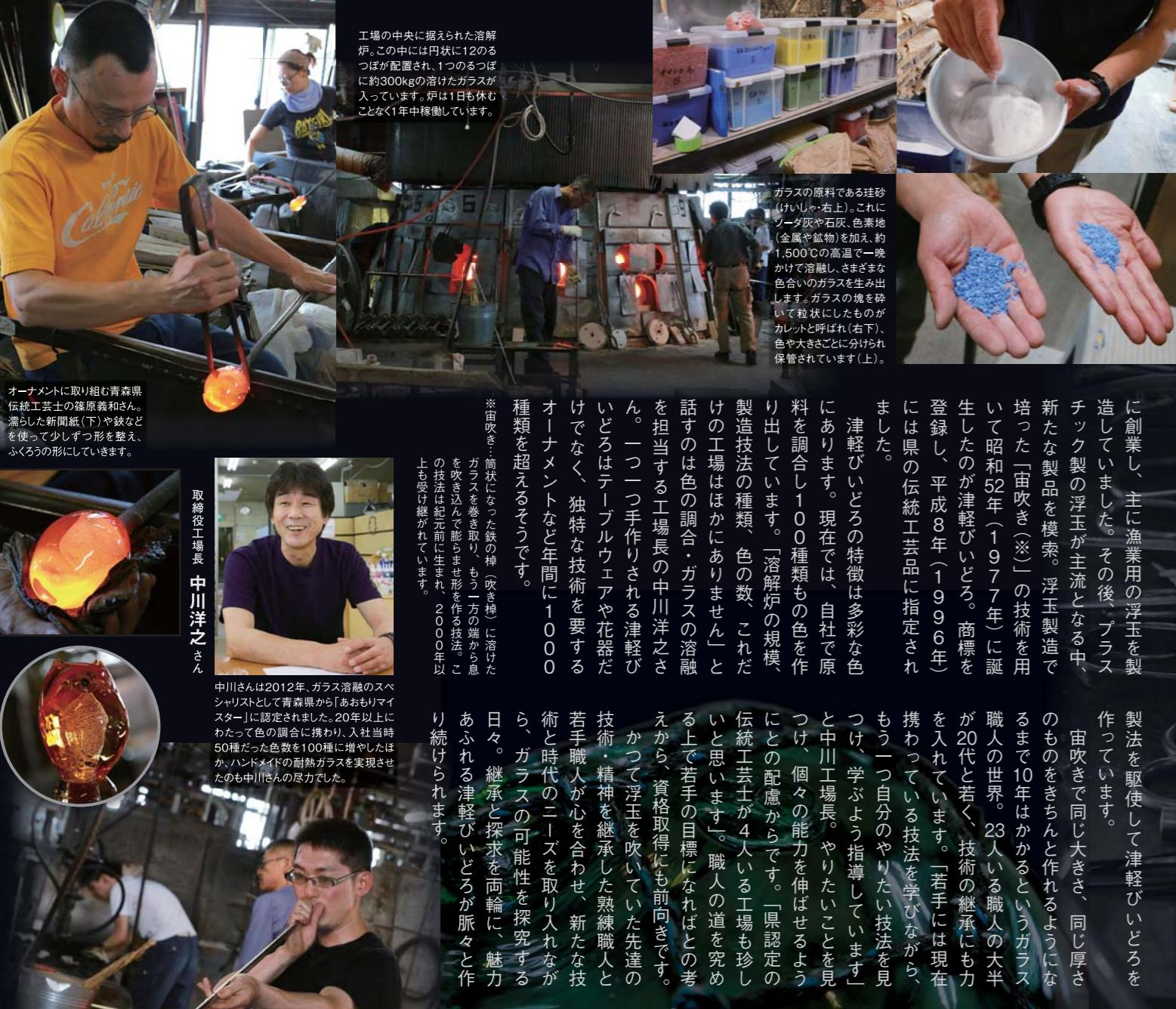
工場の中央に据えられた溶解炉、この中には円柱に12のつばが配置され、1つのつばに約300kgの溶けたガラスが入っています。炉は1日も休むことなく1年中稼働しています。
