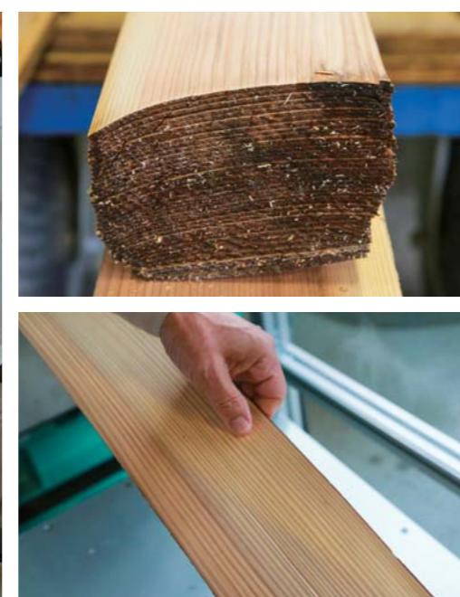
②製材後、角材から3~5ミリ程度にスライスしたものに圧密加工を施し、強度を高めます。
