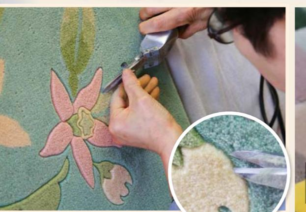
模様の輪郭を電動のハサミでカット。カービングを施すと絵柄が浮き出し、より立体的に見えます。
