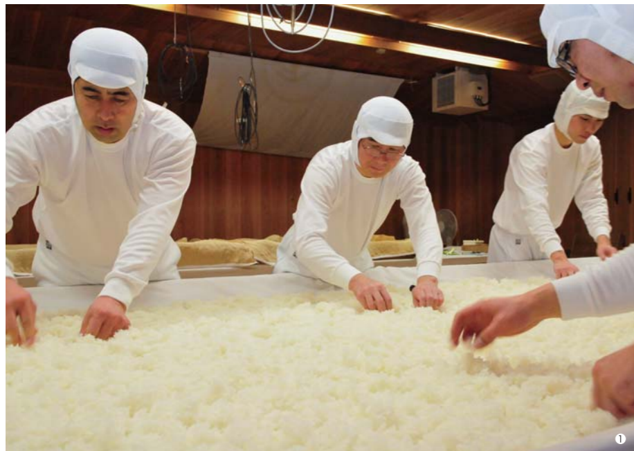
①麴造りはその後の造りを左右する大切な工程。徹底した温度・湿度管理のもと行われます。
