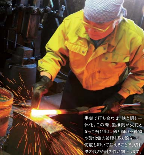
一旦、地鉄を炉から出し、鍛接剤(たんせつざい)を撒き、鋼を乗せて再び炉で熱します。鍛接剤は酸化鉄の粉と薬品を調合したもので、地鉄と鋼を接着する役割を果たします。
