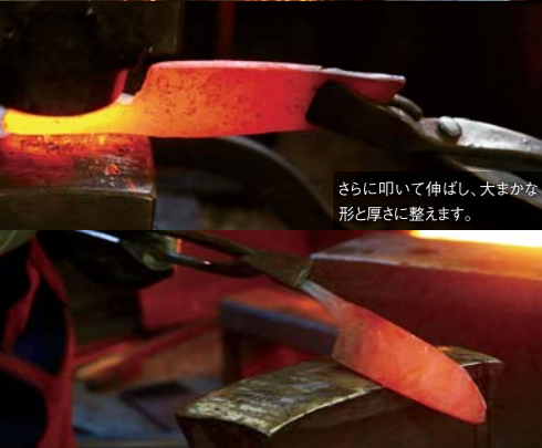
手鎚で打ち合わせ、鉄と鋼を一体化。この際、鍛接剤が火花となって飛び出し、鉄と鋼の不純物や酸化鉄の被膜を取り除きます。何度も叩いて鍛えることで、切れ味の良さや耐久性が向上します。
