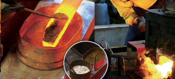
一旦、地鉄を炉から出し、鍛接剤(たんせつざい)を撒き、鋼を乗せて再び炉で熱します。鍛接剤は酸化鉄の粉と薬品を調合したもので、地鉄と鋼を接着する役割を果たします。
