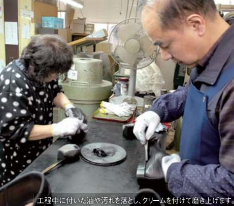
工程中に付いた油や汚れを落とし、クリームを付けて磨き上げます。
