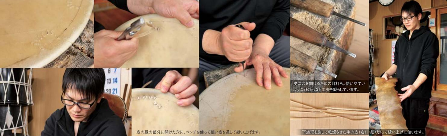
皮の縁の部分に開けた穴に、ベンチを使って細い皮を通して縫い上げます。
