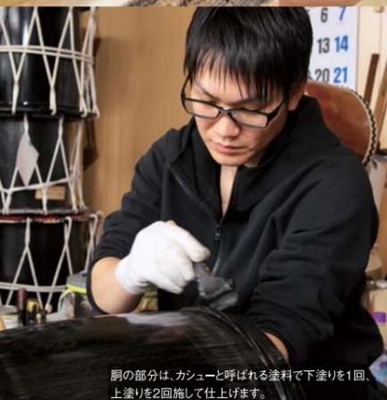
胴の部分は、カシューと呼ばれる塗料で下塗り1回、上塗りを2回施して仕上げます。
