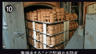
素焼きすることで型崩れを防ぎ、釉薬の定着も良くなります。温度は約800℃
