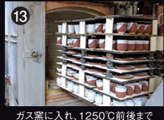
ガス窯に入れ、1250℃前後までゆっくり温度を上げて焼成(本焼き)
