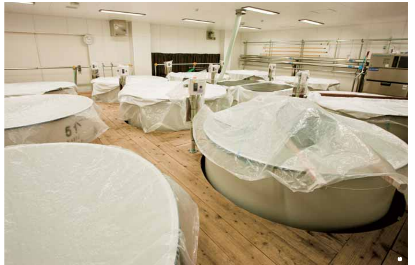
①約6,000リットルの仕込みタンク。発酵中のタンクからはフルーティーな香りが漂います。
