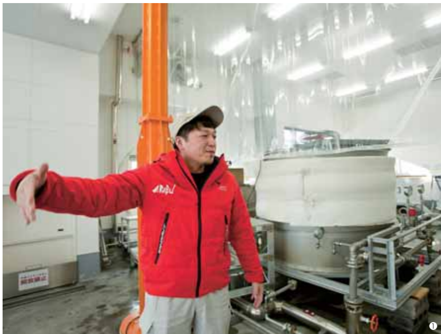
①洗米の工程を説明する龍之介さん。米を移動させる小さなクレーンを導入したり、機材にキャスターをつけて運びやすくするなど工夫されています。
