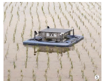
③有機農業を中心に、経営に必要なことを座学と実践を通じて学ぶ2年制の農業経営者育成学校。ヤマガタデザインが運営しています。 ④農業による環境負荷の低減と、庄内地方の農業者の所得向上を目指して上げた、有機農業の新ブランド「ショウナイリーツ」。ホテル売店でも販売されています。 ⑤ヤマガタデザインでは、有機農業を軸とした事業の一つとして、ハード開発も展開しています。写真は、同社グループ会社の有機米デザインが開発した、田んぼの除草の手間を最小化する自動除草ロボット。
