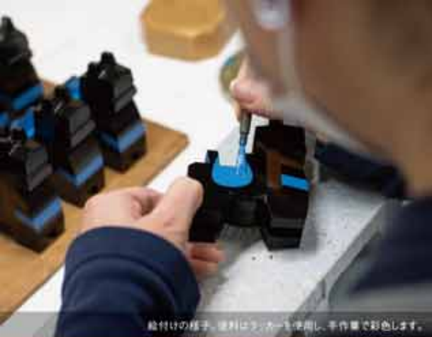
絵付けの様子。塗料はスプレーを使用し、手作業で彩色します。
