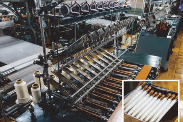
緯糸は専用の管に巻き直して準備します。
