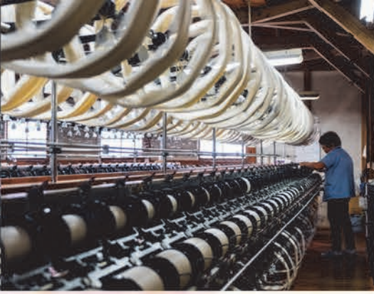
一つの枠に巻いた糸は約8,000m。ポビンに巻き直すのに3日ほどかかります。
