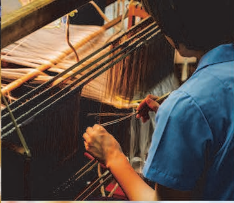
3mmほどの穴に経糸を通していく通緯(つうろう)と呼ばれる作業の様子。10,000本の経糸を通すのに、ベテランの職人でも3~4日かかるそうです。
