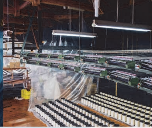
経糸の本数は薄手の生地で10,000本、フェアリー・フェザーだと13,000本にもなります。
