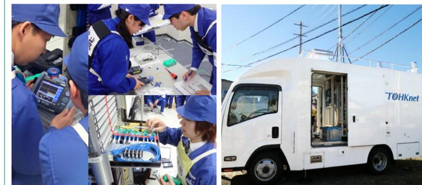
通信の品質と信頼を支える様々な施策を実行に移している東北インテリジェント通信。今年4月には社内技能競技会を初開催し、スキルやノウハウの共有とともに、社員の技能向上を行っている（左）。また、局舎被災時に代替局舎となる移動通信車を開発。1台で100回線分を賄うことができる（右）
